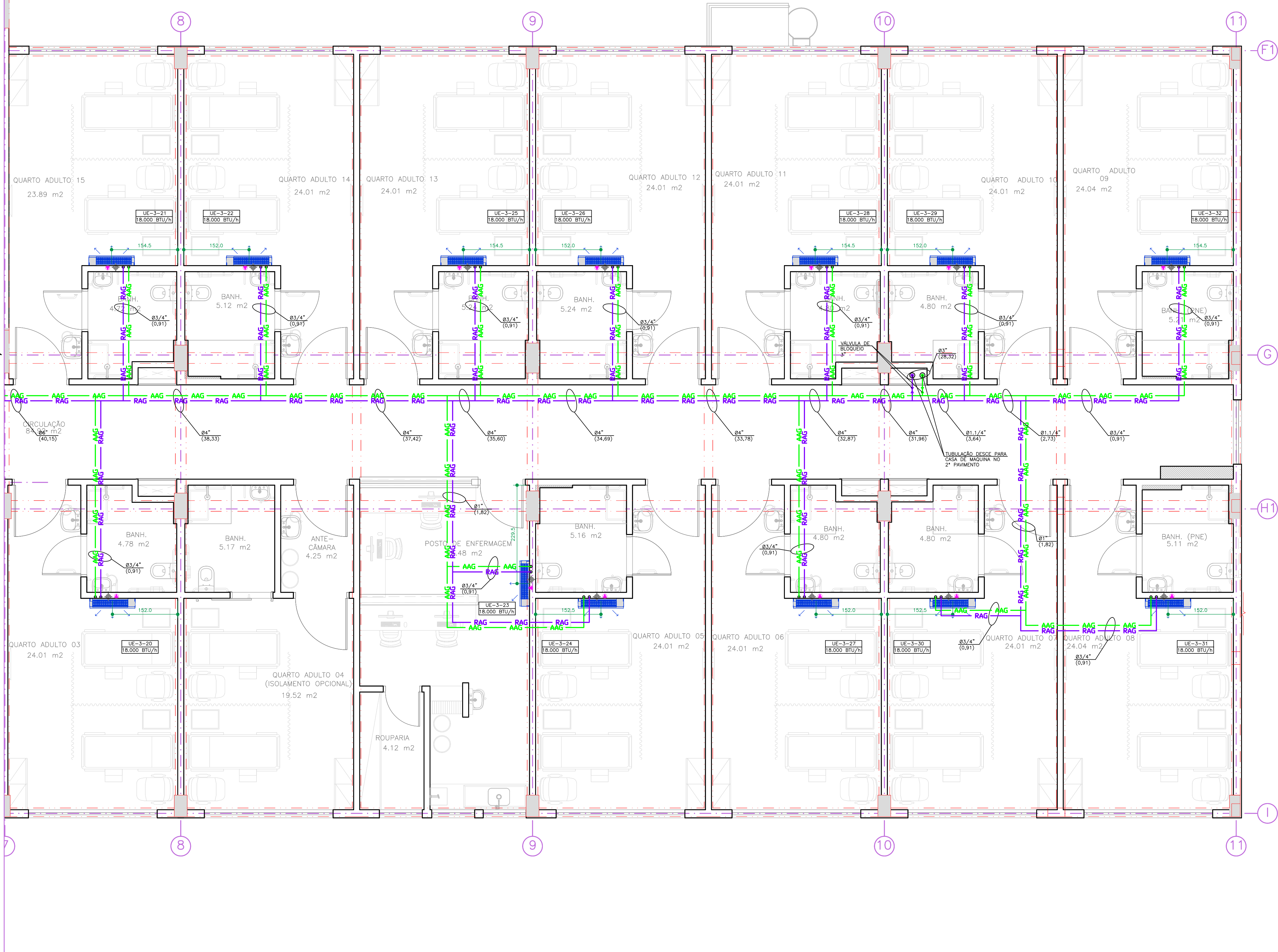
OBJS: ESTRUTURA APRESENTADA RETRATA A ESTRUTURA DO PISO DO 4º PAVIMENTO PLANTA 3º PAVIMENTO – REDE FRIGORÍGENA – PARTE 03/03 ESCALA 1 : 50
